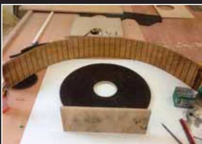
Kotelon seinämät vaimennettiin Silent Coat matolla. Kotelon istuvuus varapyörän syvennykseen on hyvä ja kaikki tila on hyödynnetty.
