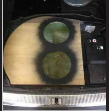
▲ Subbarikotelo kahdelle Brax Matrix -elementille syntyi varapyöräsyvennyksen perinteisellä tyyllillä lasikuitua sekä vanerilevyjä käyttämällä.
