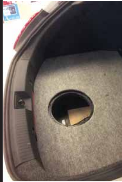
Kotelon päälle leikattiin vanerilevystä peitepaneeli, joka verhoiltiin harmaalla huovalla. Subbarin suojaus hoidettiin metalliritilällä.
