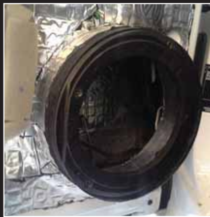
▲ Kotelolon kiinnitys on toteutettu varapyörän alkuperäiseen kiinnityspisteeseen.
