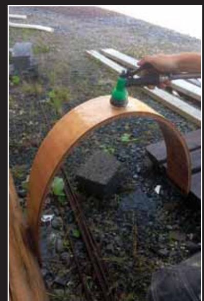
Vanerilevystä lähdettiin tekemään koteloa varapyörän tilalle. Levyä taivuttamalla saatiin aikaan puolikaaren muotoinen sivuseinä.
