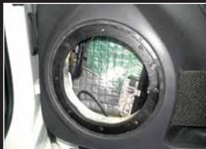
▲ ► Herkullinen kuva-sarja auton omistajan kilpailudokumentaatiosta kertoo, miten ovikaiutinasennus on syntynyt vaihe vaiheelta. Beetlen ovi vaimennettiin ja lisäksi alkuperäisen kaiuttimen paikalle tehtiin vanerista asennuskaulus Brax Matrix 6.1 keskiäänikaiuttimelle. Erittäin asiallista, mutta ei yliampuvaa.
