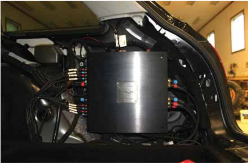
▲ ► Vahvistimen kiinnitysräkki valmistettiin raudasta. Vahvistimet löysivät paikkansa takakontin molemmin puolin alkuperäisten paneelien takaa.
