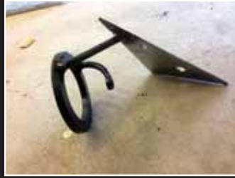
Beetlen peilikolmioihin tehtiin kiinnitystelinet Brax Nox 28 -diskanteille. Raudasta valmistetut telineet ovat varmasti tukevat, mutta suuntauksen muuttaminen ei ole mahdollista.
