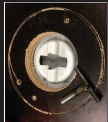
▲ Kotelolon kiinnitys on toteutettu varapyörän alkuperäiseen kiinnityspisteeseen.
