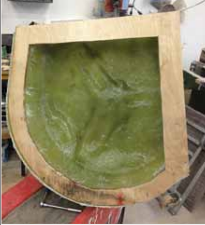
▲ Subbarikotelo kahdelle Brax Matrix -elementille syntyi varapyöräsyvennyksen perinteisellä tyyllillä lasikuitua sekä vanerilevyjä käyttämällä.
