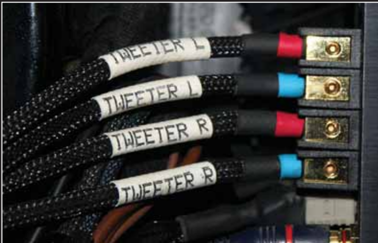
◀ Tällaisista yksityiskohdista tunnistaa Master -luokan kisa-auton. Johdotuksen viimeistely on tehty tyylikkäästi mustalla punossukalla sekä värikoodatuilla kutistesukilla. Lisäksi jokainen kaapeli on merkitty selkeästi nimilapulla.
