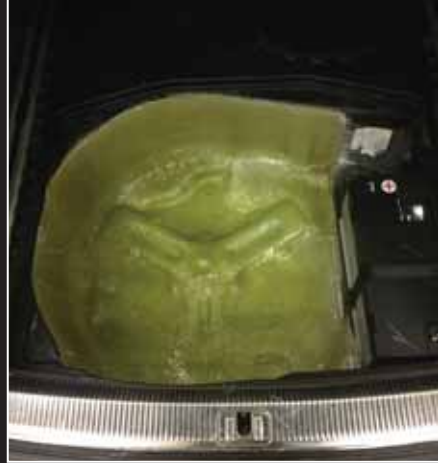
▲ Subbarikotelo kahdelle Brax Matrix -elementille syntyi varapyöräsyvennyksen perinteisellä tyyllillä lasikuitua sekä vanerilevyjä käyttämällä.
