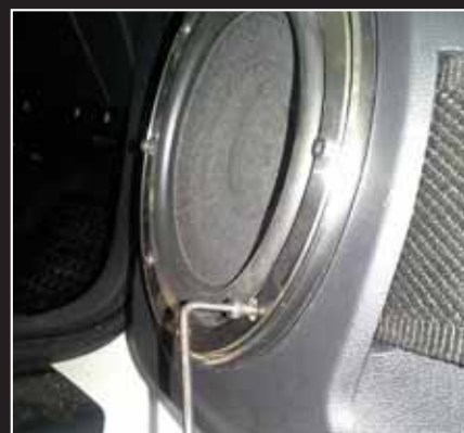
▲ ► Herkullinen kuva-sarja auton omistajan kilpailudokumentaatiosta kertoo, miten ovikaiutinasennus on syntynyt vaihe vaiheelta. Beetlen ovi vaimennettiin ja lisäksi alkuperäisen kaiuttimen paikalle tehtiin vanerista asennuskaulus Brax Matrix 6.1 keskiäänikaiuttimelle. Erittäin asiallista, mutta ei yliampuvaa.
