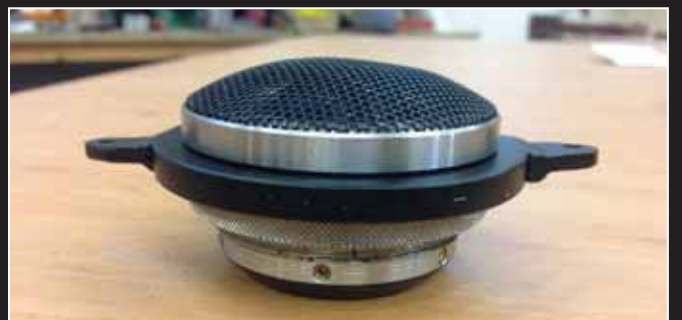
▲ Brax Matrix diskantit asennettiin metallista valmistetuissa asennuslaipoissa kojelaudan kulmiin porattuihin reikiin. Valtavirrasta poiketen ääni heijastetaan siis tuulilasista kuuntelijan korviin.
