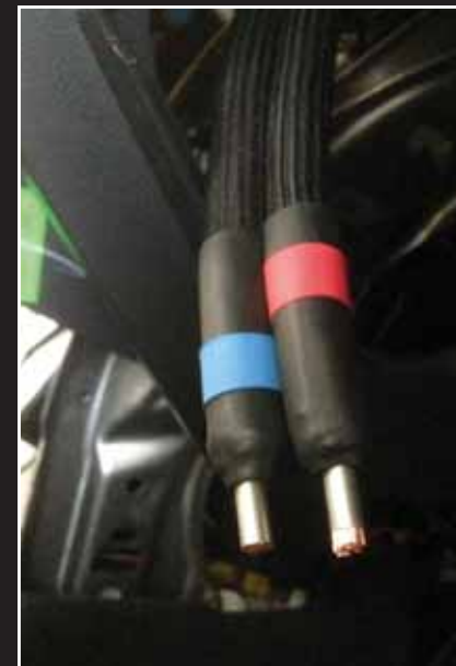
▲ Vahvistimen virtakaapelit suojattiin punossukalla ja merkittiin värillisellä kutistesukalla.
