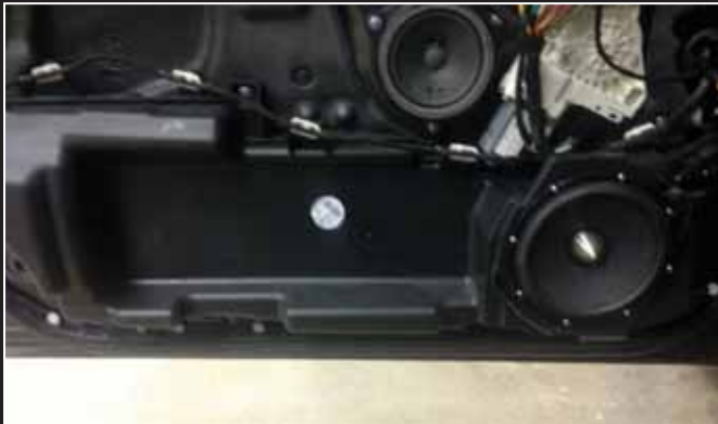
▲ Kuvassa Audin ovi lähes vakiona. Braxin keskiäänikaiutinta sovitellaan paikalleen alkuperäiseen suljettuun koteloon. Yläpuolella sijaitseva kaiutin on auton alkuperäinen.
