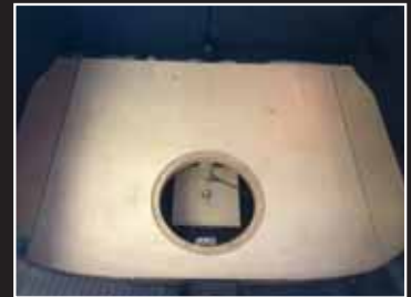
Kotelon päälle leikattiin vanerilevystä peitepaneeli, joka verhoiltiin harmaalla huovalla. Subbarin suojaus hoidettiin metalliritilällä.
