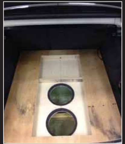
▲ Subbarikotelo kahdelle Brax Matrix -elementille syntyi varapyöräsyvennyksen perinteisellä tyyllillä lasikuitua sekä vanerilevyjä käyttämällä.
