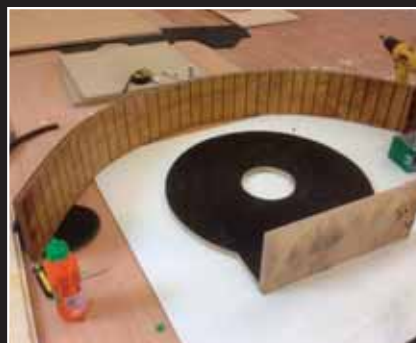
Vanerilevystä lähdettiin tekemään koteloa varapyörän tilalle. Levyä taivuttamalla saatiin aikaan puolikaaren muotoinen sivuseinä.
