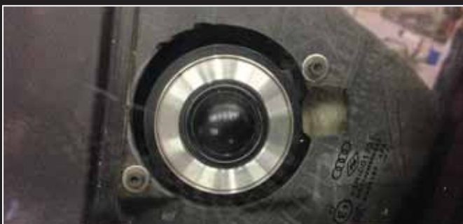
▲ Brax Matrix diskantit asennettiin metallista valmistetuissa asennuslaipoissa kojelaudan kulmiin porattuihin reikiin. Valtavirrasta poiketen ääni heijastetaan siis tuulilasista kuuntelijan korviin.
